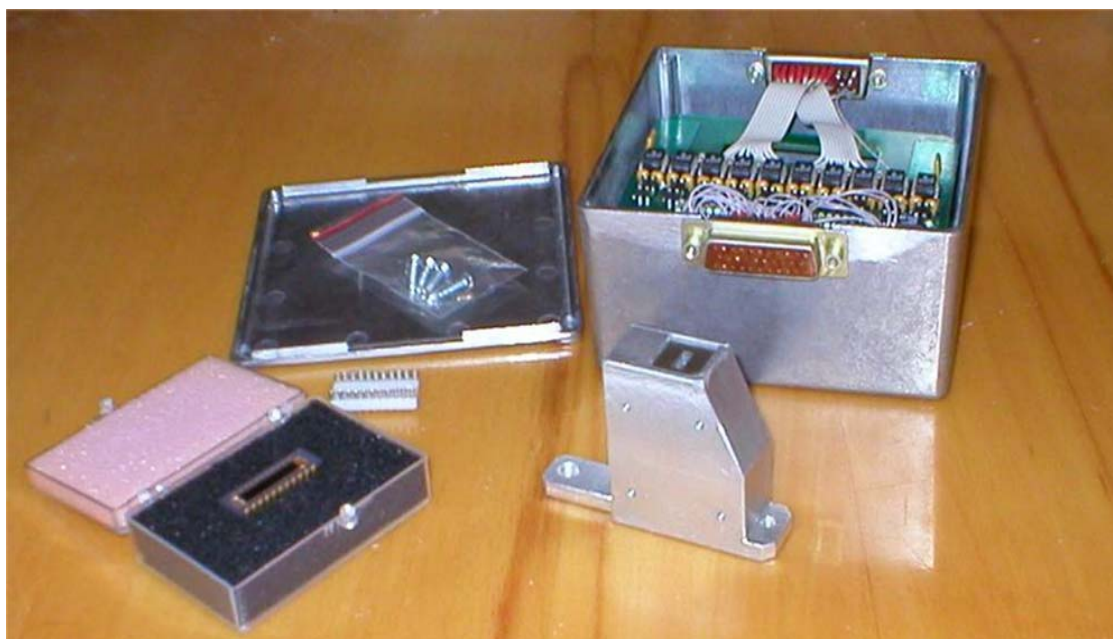
Obr.2.5 Fotografie AXUV diod, zesilovače a detektorového krytu
