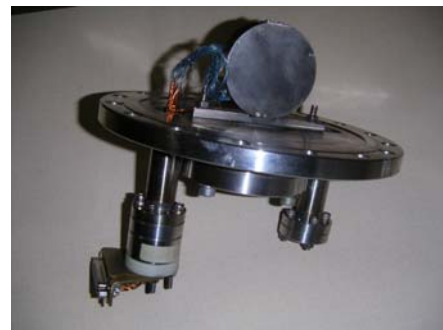
Obr.2.10 fotografie krytu pro AXUV2 a jeho umístění na přírubě
