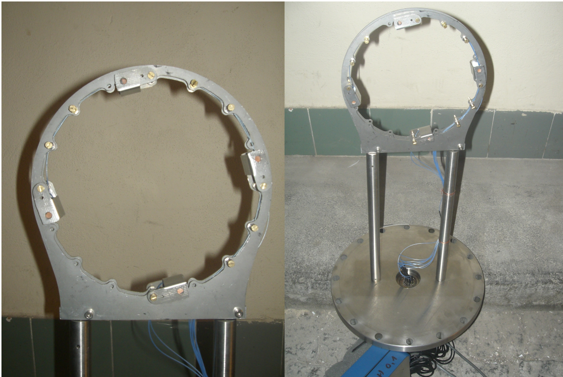
Obr. 6.8: Ring 4 Machových sond inštalovaných na tokamaku Golem.
