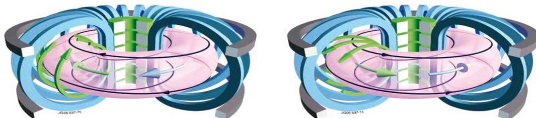
Obrázek 4: Důsledky obrácení proudu plazmatem a toroidálního magnetického pole v tokamaku.
