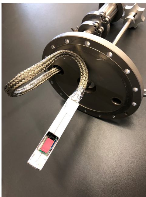
Obrázek 4.2: Detektor PH32 v kovovém stínění a připevněném na radiálním manipulátoru.
