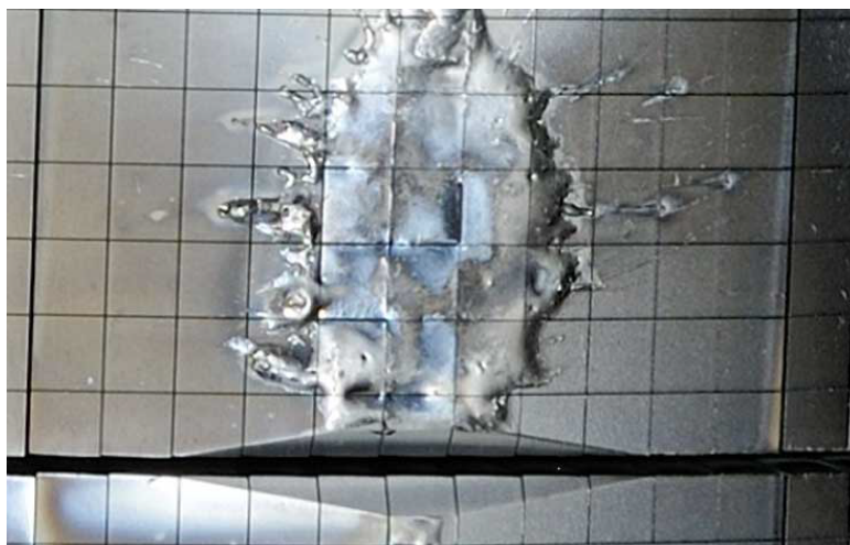
Obrázek 2: Poškozená vakuová komora tokamaku JET po nárazu ubíhajících elektronů [5].
