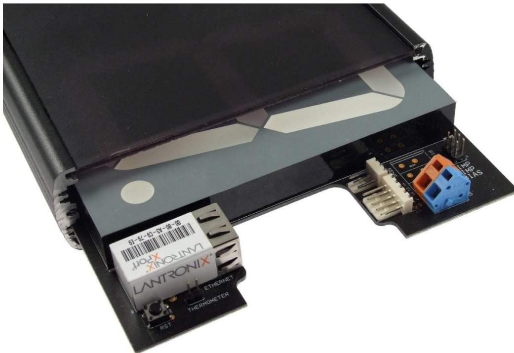
obr. 4 – TDS101 ETH: odmontovaná bočnice a povysunutá deska elektroniky
