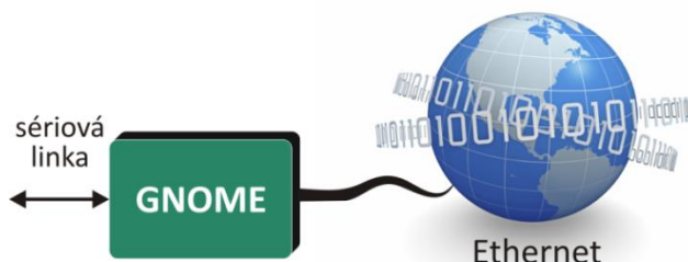
obr. 8 – typické zapojení GNOME jako převodníku Ethernetu – sériová linka
