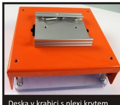
Deska v krabici s plexi krytem a držákem na DIN (zespodu)
