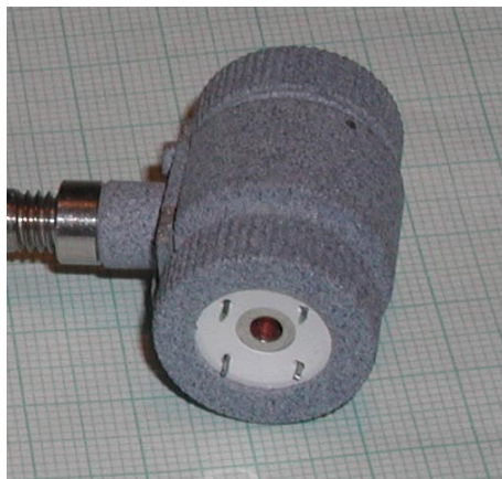
Obrázek 6.6: Pohled na Katsumatovu sondu použitou na tokamaku Castor při experimentech v roce 2002. Aktivní plocha tunelu je uprostřed, lesklé mezikruží tvoří clonku odstiňující elektrony – jeho vyjmutím získáme tunelovou sondu. Okolo tunelu jsou umístěny 4 jednoduché Langmuirovy sondy, které umožňují monitorování parametrů plazmatu vně sondy, před vstupem do tunelu.
