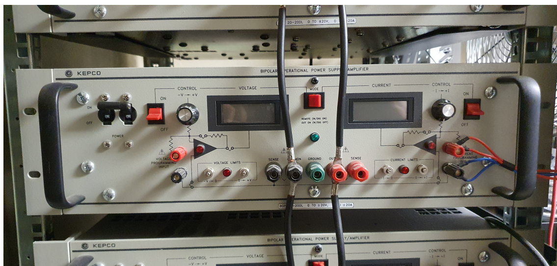
Obrázek 2.13: Foto proudového zesilovače KEPCO, konfigurace 20 V/20 A. Tento zesilovač společně s dalšími mezi sebou propojenými slouží pro stabilizaci polohy plazmatu na tokamaku GOLEM.
