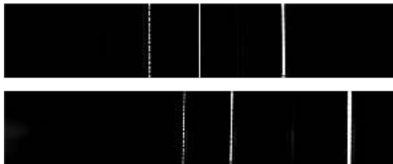
Obrázek 4.2: Použitý pár snímků výbojek, horní snímek z kamery R, dolní z kamery V.
