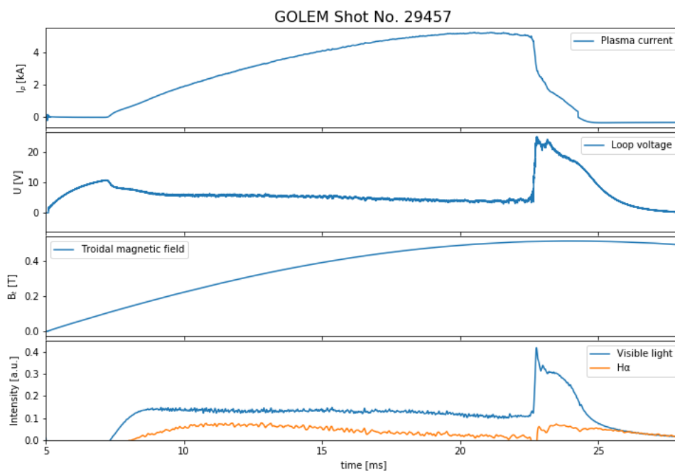
Obrázek 3.2: Ukázka signálů ze základních diagnostik tokamaku GOLEM pro výboj 29457.
