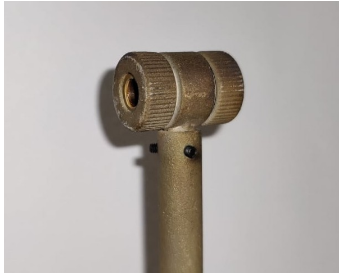
Obrázek 13: Fotografie využitě dvojitě tunelové sondy.
