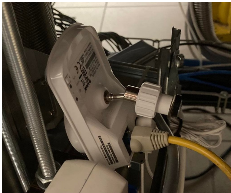
Obrázek 18: Kamera manipulátoru snímající radiální souřadnici sondy.
