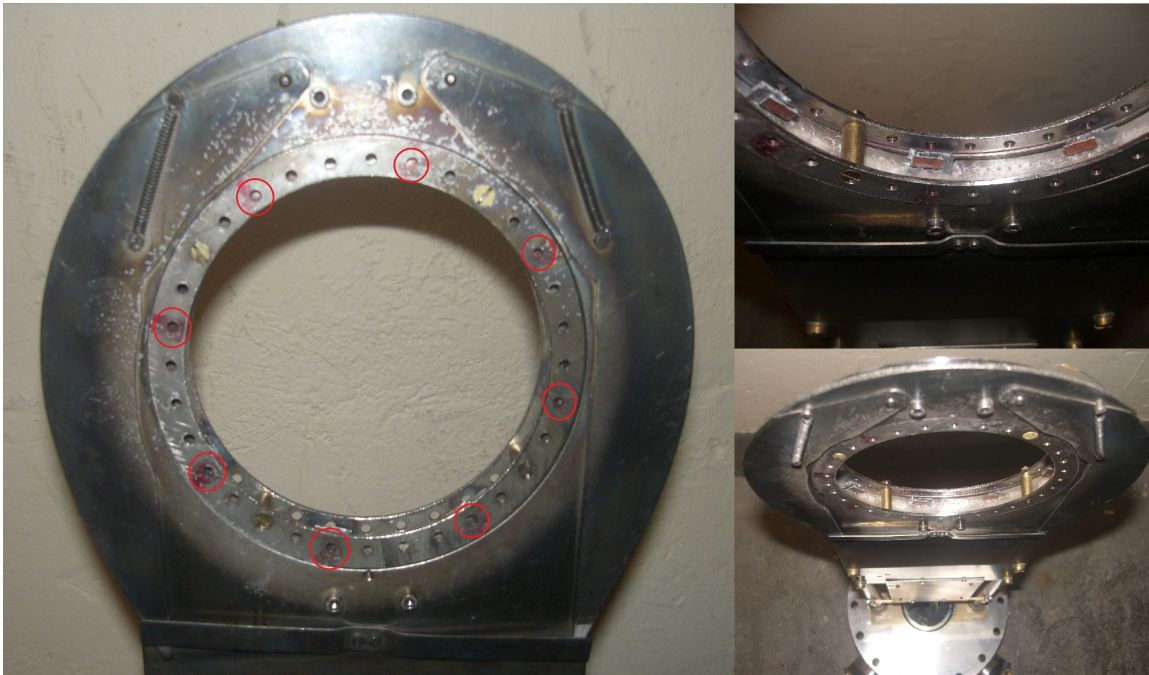
Obr. 8.1: Poloidálne pole Machových sond inštalované na tokamaku Golem.
