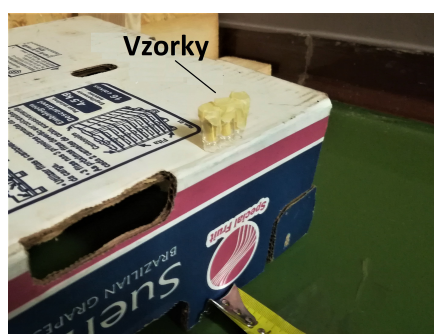
Obrázek 3.23: Vzorky ^{131}\text{I} o aktivitách 946 MBq, 352 MBq a 863 MBq při pohledu zleva doprava.
