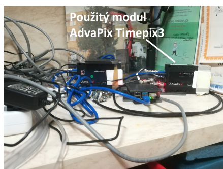
Obrázek 3.37: Fotografie umístění detektoru AdvaPix Timepix3 v laboratoři tokamaku Golem.
