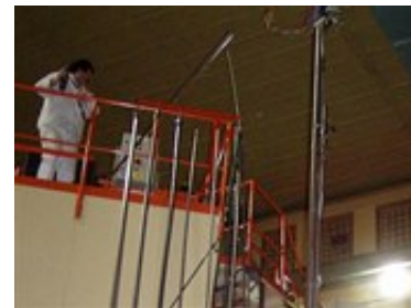
Aktivní sonda TW3 na testování vzorků první stěny reaktoru ITER před vložením do jaderného reaktoru LVR-15 v Řeži u Prahy.
