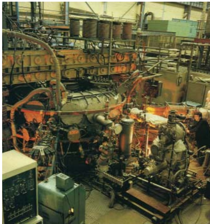
Tokamak T-7 z Ústavu pro atomovou energii I. V. Kurčatova v Moskvě zahájil v roce 1981 éru supravodivých tokamaků. Část vybavení tokamaku T-7 dodal Ústav fyziky plazmatu ČSAV
