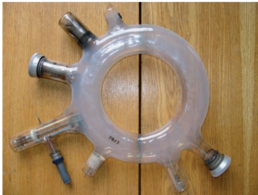
Urychlovací komora betatronu – „zakladatele“ Ústavu fyziky plazmatu ČSAV
