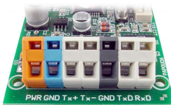
obr. 11 – Svorky pro napájení a sériové linky – příklad z Quida RS 3/0
