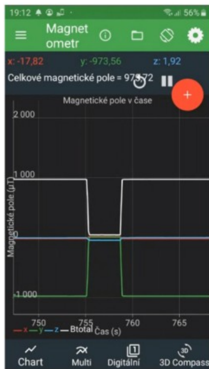
Obr 1: Magnetické pole naměřené senzorem mobilního telefonu. Vlevo magnetické pole generované vertikální stabilizací, vpravo pole generované horizontální stabilizací
